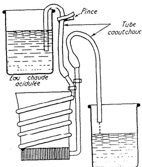
Détartrage d'un corps de chauffe.
